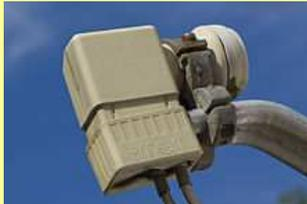
**IP-LNB** Die SES gab bekannt, dass ein IP-LNB entwickelt wurde, der direkt IP-Signale liefert und insgesamt bis zu **acht Kanäle** von jedem beliebigen Transponder einer Orbitalposition bereitstellt. Diese Kanäle können direkt per IP-Unicast oder -Multicast an ortsfeste und mobile Geräte weitergeleitet werden.<sup>[3]</sup>
